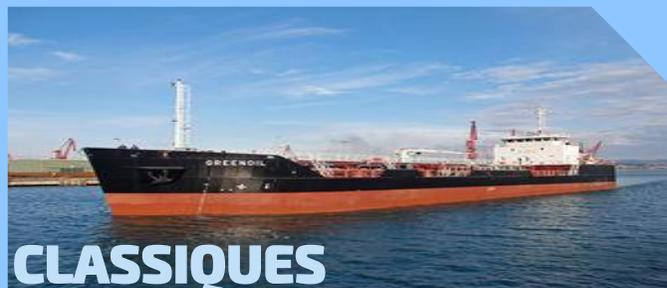
aussi appelés navires d'allègement, permettent de ravitailler les autres navires ou d'alléger les pétroliers trop volumineux
